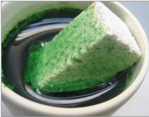
Starke Infiltration ohne ancorro-Technologie
