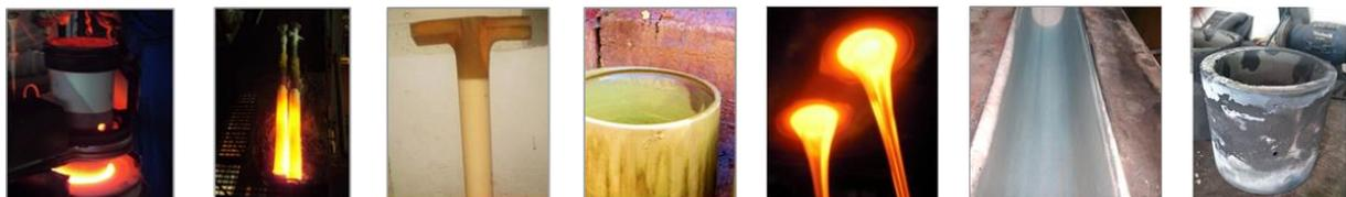
Abb. 5: ausgewählte Industrieteile, die mittels der Beschichtung in diversen Schmelzindustrien getestet wurden: Drehrohr, Plunger, Rührer, Schamottehafen, Tropfring, Gußrinne und Graphitdruckring (v.l.n.r.).
