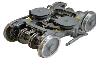
Generator / Motor Erzeugen im ICE Strom beim Bremsen
