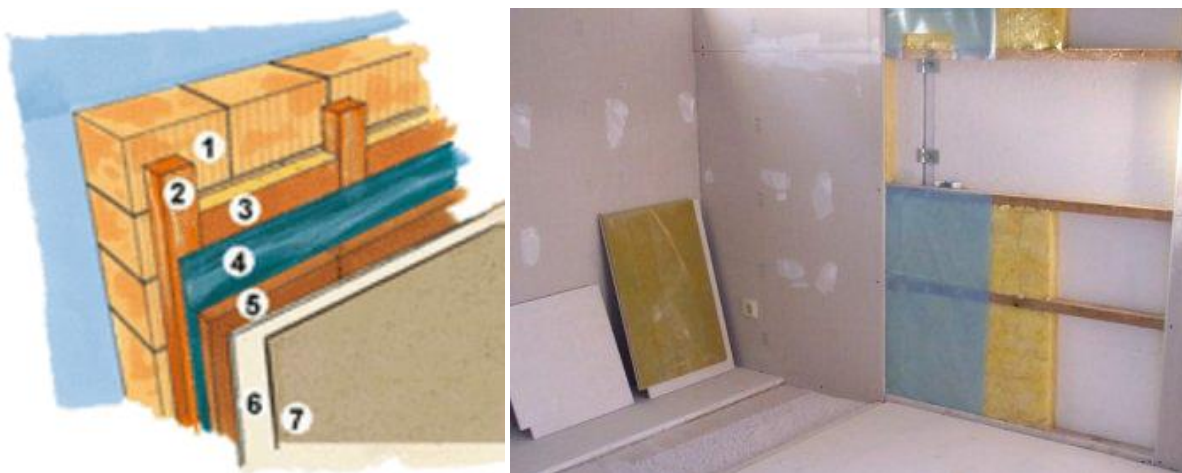
Abbildung 6-20: Aufbau einer Innenwanddämmung (links, Quelle: energiesparen-im-haushalt.de , 2013), Anbringung einer Innenwanddämmung (rechts, Quelle: 3s-selbstbau-berlin.de , 2013)
