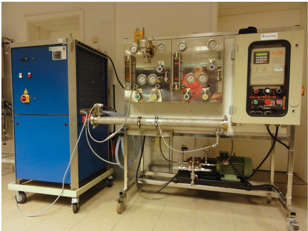
Abbildung 1: Versuchsanlage mit eingebautem Wickelmodul und externem Kühler
