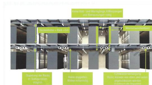
Die Rechenzentren sind einfach und kompakt aufgebaut
