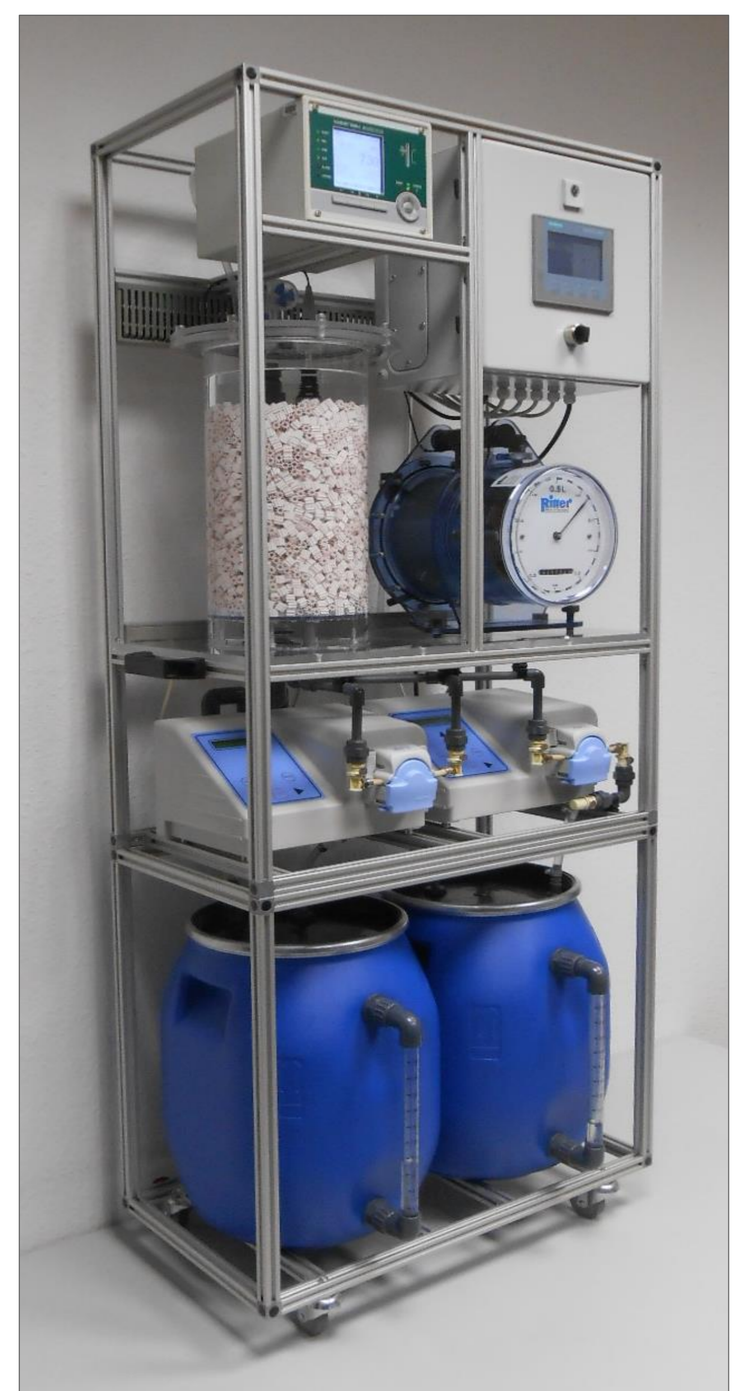
Versuchsanlage nach Flexbioverfahren
